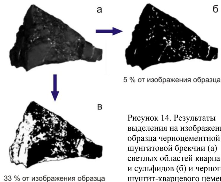
Рисунок 14. Результаты выделения на изображении образца черноцементной шунгитовой брекчии (а) светлых областей кварца и сульфидов (б) и черного шунгит-кварцевого цемента (в)
