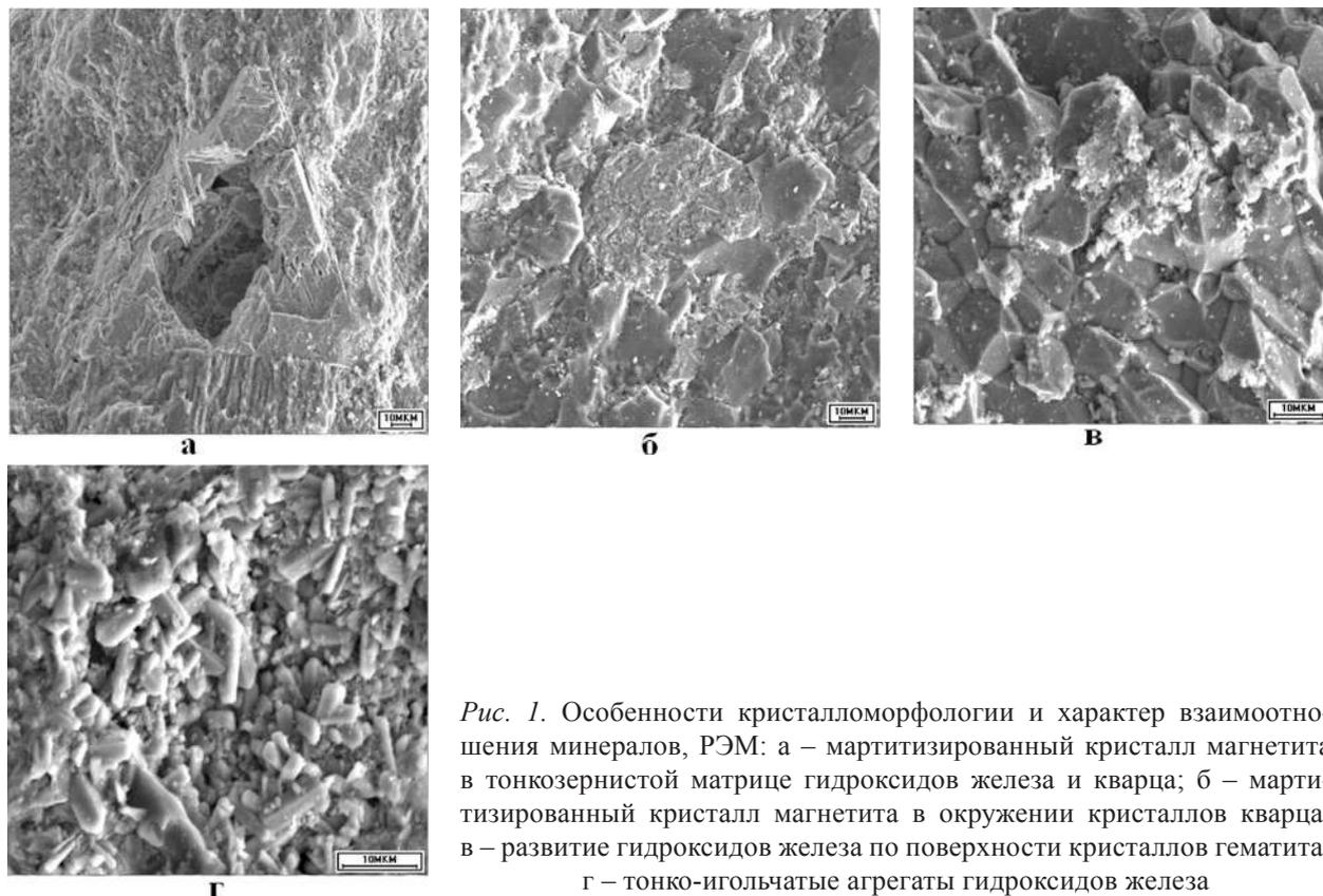
Рис. 1. Особенности кристалломорфологии и характер взаимоотношения минералов, РЭМ: а – мартитизированный кристалл магнетита в тонкозернистой матрице гидроксидов железа и кварца; б – мартитизированный кристалл магнетита в окружении кристаллов кварца; в – развитие гидроксидов железа по поверхности кристаллов гематита; г – тонко-игольчатые агрегаты гидроксидов железа
