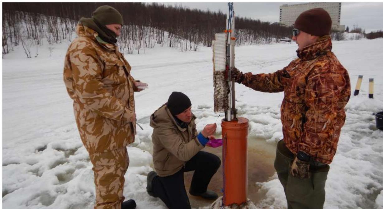
*Рис. 12.* Процесс разбора колонки донных отложений, отобранной Limnos'ом (г. Мурманск, оз. Окуневое, 2019), фото А. В. Гузевой
