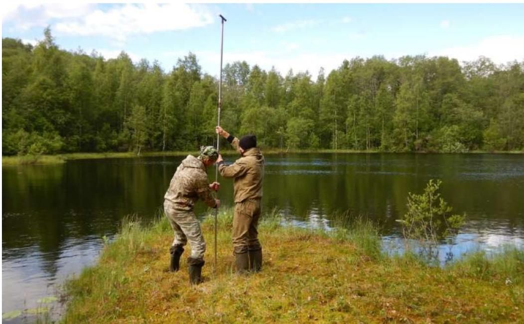
*Рис. 8.* Отбор керна донных отложений безымянного озера в Суоярвском р-не РК при помощи русского бура со сплавины (слева З. И. Слукровский, справа А. С. Медведев), фото Т. С. Шелеховой
